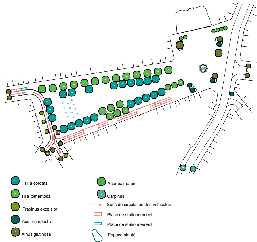
Schéma de la proposition de fonctionnement de la place Saint-Denis du permis d'urbanisme
